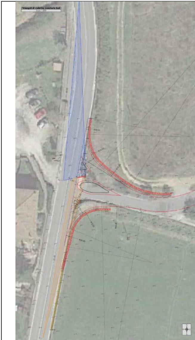
Figura 4.3 - Triangoli di visibilità per immissione direzione Sud
