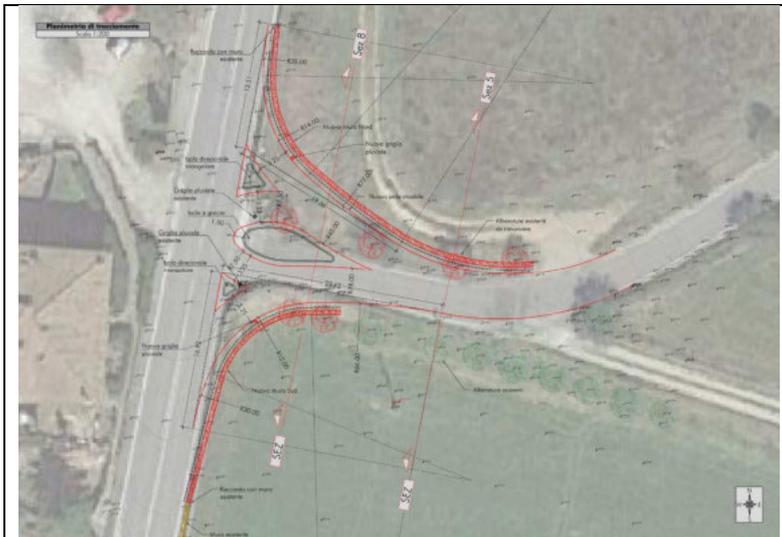
Figura 4.2 - Parametri isola centrale e tricentriche di progetto
