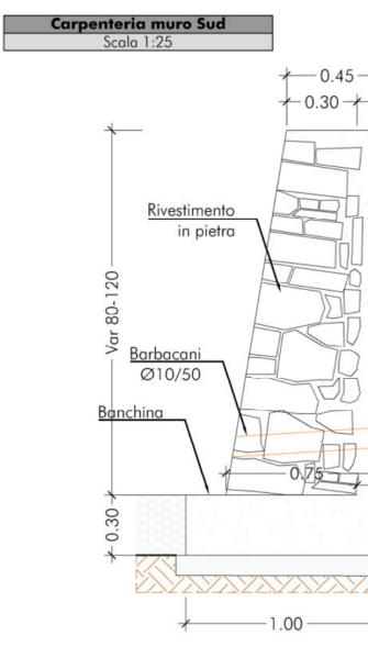
N.B. Il nuovo muro Sud viene realizzato con gli stessi criteri del muro Nord (carpenteria e armatura). L'altezza varia da 1.20m fino a zero. L'anima e la fondazione in c.a. dovranno essere adoperati fino ad una altezza del muro fuori terra di 1,00m per poi proseguire a gravità adoperando il materiale lapideo ricavato dalla demolizione del muro attuale
